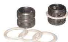
Se recomienda utilizar únicamente los manguios Cordivari. El uso de otros manguios no garantiza el sellado de el radiador y excluye la garantía. Todas baterías de la misma altura se pueden acoplar a partir de un mínimo de 3 secciones. En la operación de acoplamiento no exceda una fuerza mayor de 10 kg por metro. La junta especial de silicona blanca garantiza un sellado hidráulico perfecto.
