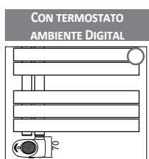
El volumen global del radiador en altura debe calcularse teniendo en cuenta la altura del termostato.
