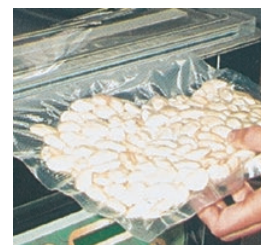
Posibilidad de realizar el envasado al vacío de forma exterior, lo que permite envasar productos de gran longitud.
